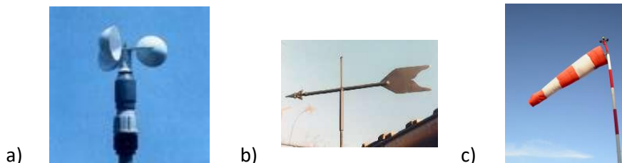
Abbildung 19: Beispiel eines Anemometers (a), einer Windfahne (b) und eines Windsacks (c) ( www.meteole.net )
