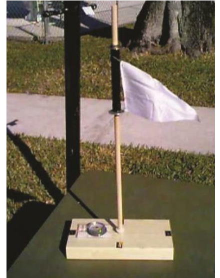
Figura 1: strumento di misura per la direzione del vento. © GLOBE internazionale
