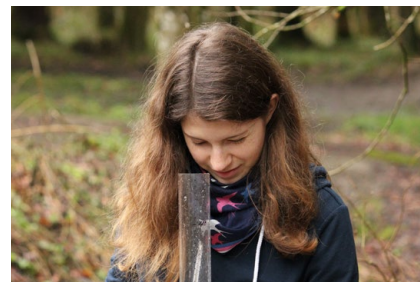
Figura 3: un'allieva verifica la trasparenza di un corpo idrico mediante il tubo per la trasparenza. © Corinne Lehmann / GLOBE Svizzera
