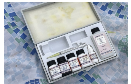
Figure 6 : la teneur en oxygène de l'eau, obtenue à l'aide d'un set d'analyses chimiques, est d'une importance capitale pour les macroinvertébrés. Elle dépend directement de la température de l'eau. © Daria Göllnitz / GLOBE Suisse
