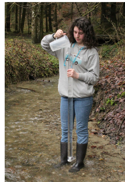
Figure 1 : pour mesurer la transparence, une élève verse de l'eau dans le tube de mesure. © Daria Göllnitz / GLOBE Suisse
