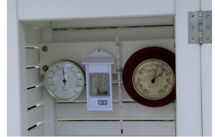
Abbildung 1: Die Messinstrumente im Wetterhaus liefern Atmosphäre-Daten, welche mit den Daten von MeteoSchweiz verglichen werden können. © GLOBE Schweiz
